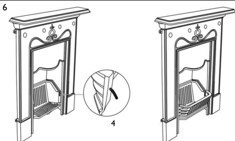
Зафиксируйте 2 крепежные шпильки с обратной стороны декоративной решетки (рис.4).
